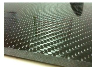
**RESOLTECH HTGL 160 / HTGL 166** est un système époxy spécialement formulée pour la réalisation de **moules et de pièces composites structurales** exigeants des  $T_G$  élevées pouvant aller jusqu'à **160°C**.
