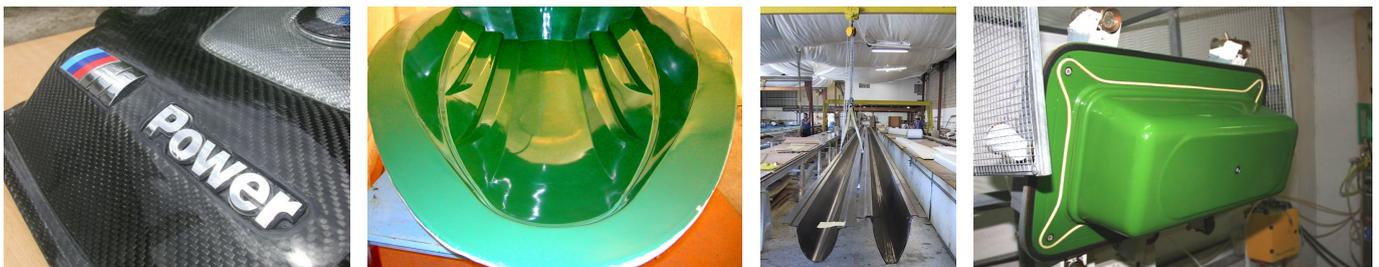
Le système époxy **RESOLCOAT 7090 / 7091(T)** est un gelcoat disponible en version **CLEAR**, **NOIR**, **BLANC**. La version CLEAR peut-être teintée avec les pigments broyés époxy du nuancier RAL, il faut rajouter 5% de pigment dans la partie résine avant mélange. On préconise le durcisseur **7091** pour le **7090 CLEAR** et le durcisseur thixotrope **7091T** pour les versions colorées.
