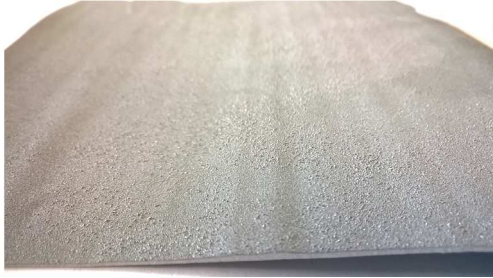
Dos du gelcoat après poudrage
